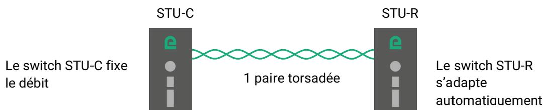
**Un des switches est normalement configuré en STU-C et l'autre en STU-R. Cependant, pour rendre la configuration plus simple, le switch configuré en STU-C est capable de basculer automatiquement en mode STU-R s'il détecte la présence en face d'un autre STU-C. Ainsi deux XS configurés tous les deux en STU-C trouveront le moyen de se connecter. L'un des deux basculera en STU-R.**
