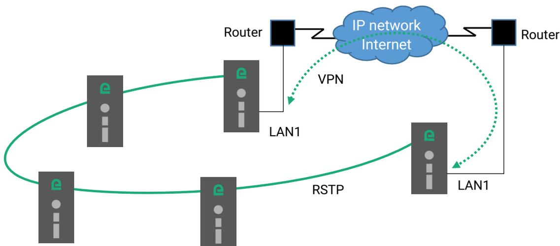
Les 2 XS d'extrémité établissent un VPN à travers le réseau WAN. Ce VPN assure une connectivité au niveau Ethernet. Ainsi en activant le protocole RSTP la redondance peut être assurée par ce VPN.
