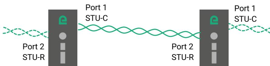
Ou bien encore quand on relie un XS 4 ports utilisé en concentrateur avec des XS 1 port comme dans le schéma ci-dessous.
