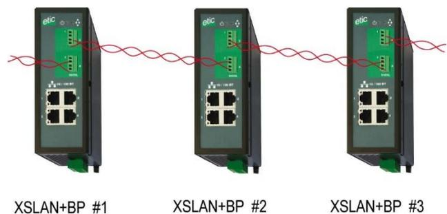
Après quelques secondes, le XSLAN+ #1 établit la connexion SHDSL avec le XSLAN+ #3.
