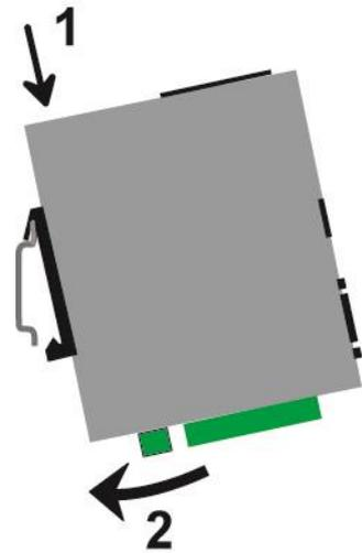
Pour démonter le produit du rail Din 35 mm,
