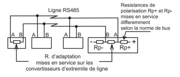
Les convertisseurs RS232 / RS485 de type SC232 permettent de convertir une interface RS232 en interface RS485 2 fils. Le SC232 ne requiert aucun règlage de débit et de format de caractère et aucun signal RS232 pour «retourner» le bus RS485. Le modèle SC232-3 n'est pas isolé.
