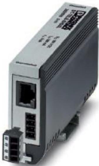
Le PS02 est dédié à la protection d'interfaces de communication SHDSL. La connexion se fait simplement par 2 borniers à vis 4 points ou 2 connecteurs RJ45 (RJ12 avec adaptateur fourni). Un kit de mise à la terre est fourni pour les produits non fixés sur un rail DIN.
