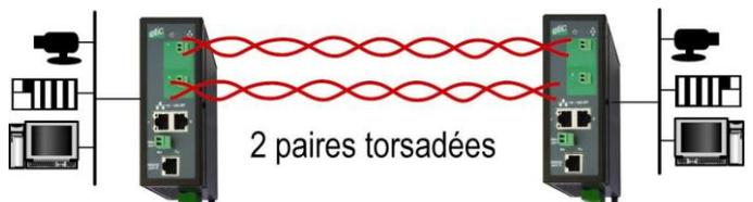
De plus, en cas de défaillance d'une des deux lignes, le fonctionnement continue d'être assuré au moyen de l'autre.
