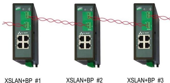
Après quelques secondes, le switch N°1 établit la connexion SHDSL avec le switch N°3.
