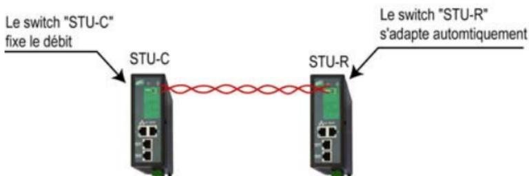
Pour rendre le paramétrage particulièrement simple, la liaison SHDSL se configure en sélectionnant un profil de connexion au moyen des micro-interrupteurs SW2 à SW5.
